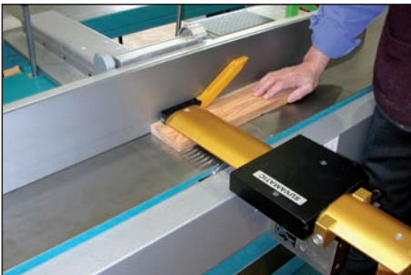
Bild 4: Betriebliche Sicherheitseinrichtung, Messerwellenabdeckung bei einer Abrichthobelmaschine
