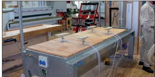
Bild 2: Arbeitsplatz für Schleifarbeiten mit Untertischabsaugung
