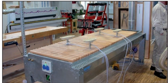
Bild 2: Arbeitsplatz für Schleifarbeiten mit Untertischabsaugung
