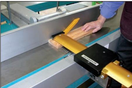
Bild 4: **Betriebliche Sicherheitseinrichtung, Messerwellenabdeckung bei einer Abbrichtobelmaschine**
