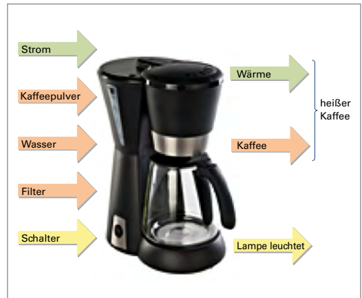
Bild 1: Kaffeemaschine als Beispiel für ein technisches System
