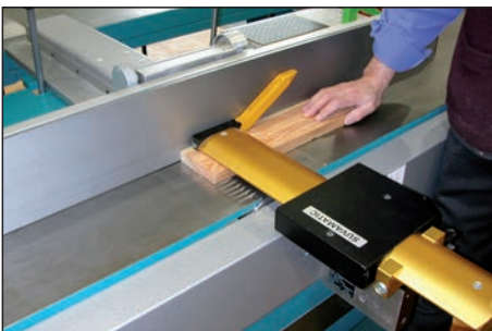
Bild 4: Betriebliche Sicherheitseinrichtung, Messerwellenabdeckung bei einer Abbrichtobelmaschine
