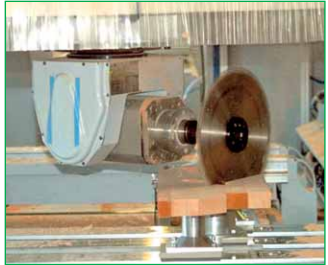
Bild 123/2: Säge mit Aufnahme, 5-achsige Bearbeitung
