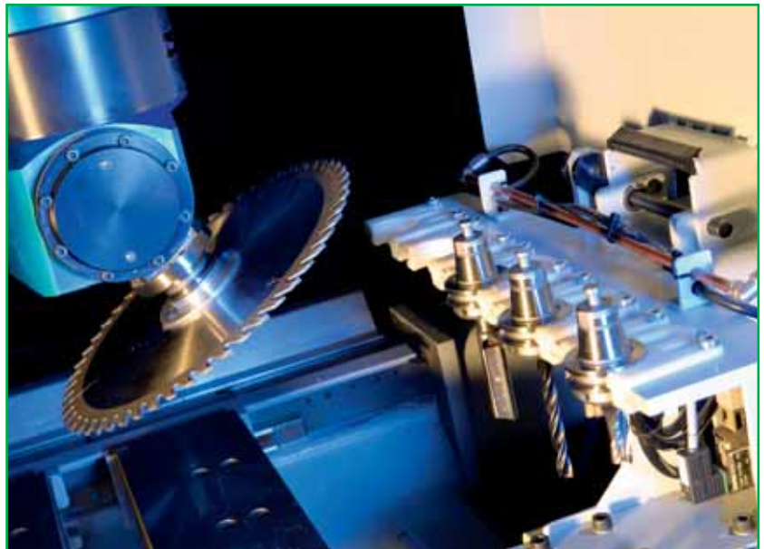
Bild 123/4: In eine 4-Achsmaschine einwechselbares 5-Achsaggregat
