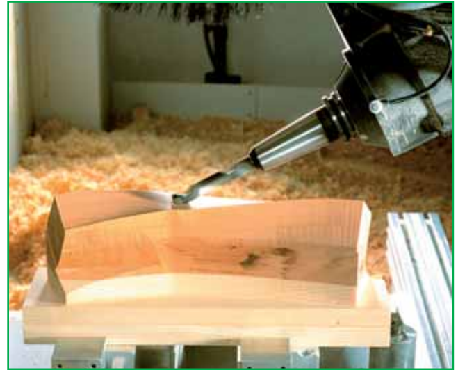
Bild 122/2: 5-Achs-Langlochbohren, 3D, Krümmling
