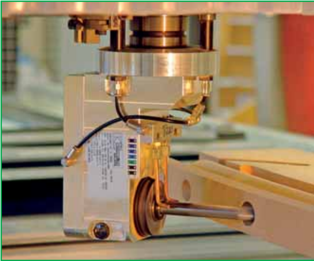
Bild 122/1: 4-Achs-Langlochaggregat, 2D, Handlauf
