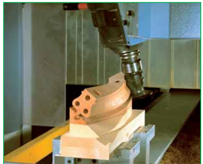
Bild 122/4: 5-Achs-Handlaufprofilfräsen, 3D, Krümmling
