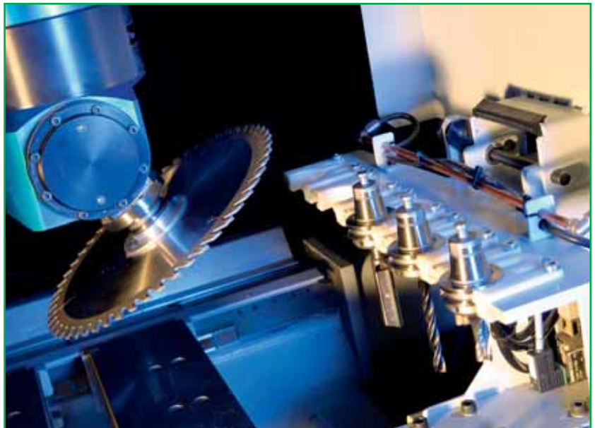
Bild 123/4: In eine 4-Achsmaschine einwechselbares 5-Achsaggregat
