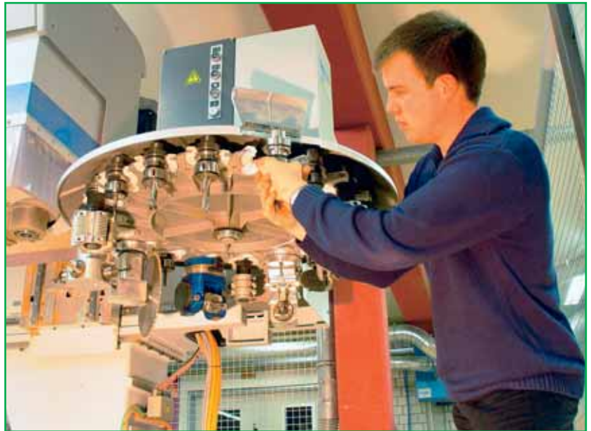
Bild 124/2: Tellerwechsler mit Handbelegung
