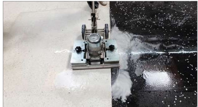
Bild 2: Test mit innovativer Reinigungsmaschine auf unterschiedlichen Terrazzobelägen
