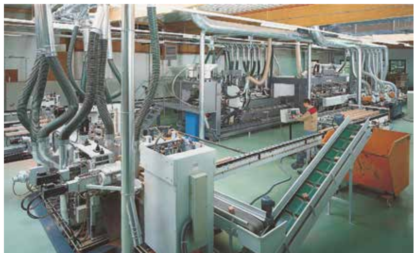
Blick in das vollautomatische CNC-gesteuerte Fräs- und Dübelzentrum
