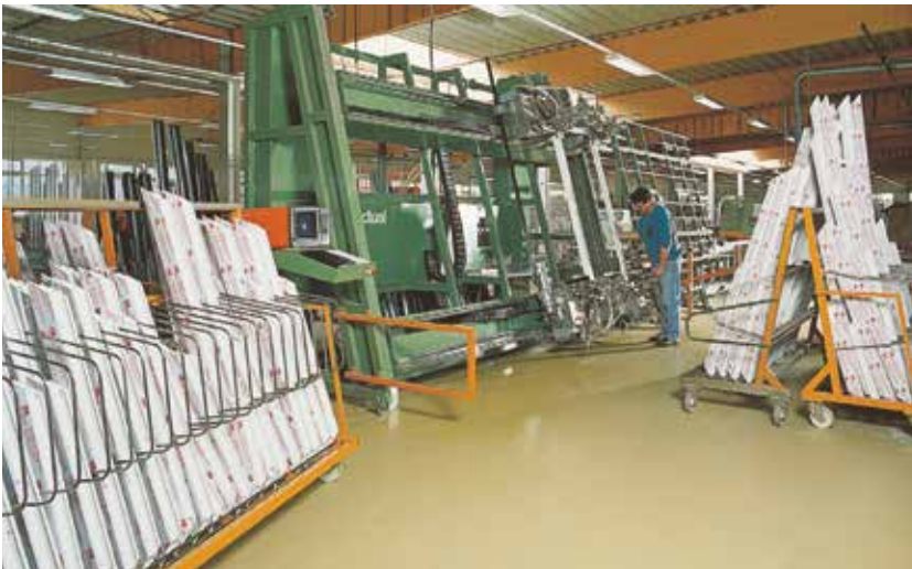
Blick in die vollautomatische Blendrahmen- und Flügelstraße
