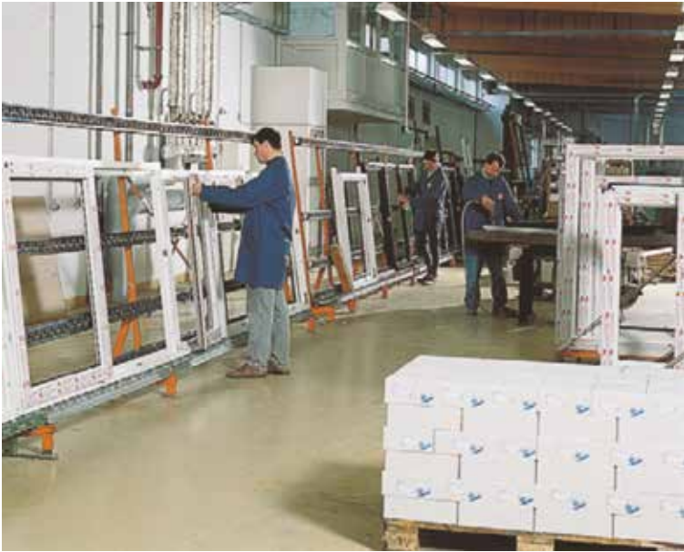
Blick in den Endanschlag einschließlich der Beschlagmontage
