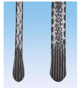
3 angeschmiedete Stabenden und geprägte Oberflächen
