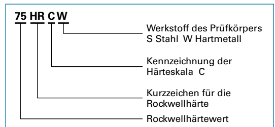
Bild 2: Normgerechte Angabe eines Rockwell-Härtewertes (Beispiel)
