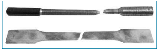
Bild 1: Zugproben nach Bruch oben: Rundstab aus Stahl – gut zu erkennen ist die Einschnürung in der Mitte unten: Flachstab aus Kupfer, nahezu ohne Einschnürung gebrochen
