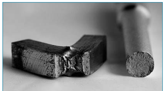
Bild 3: Vergleich von Zähbruch (links) und Spröbruch (rechts)
