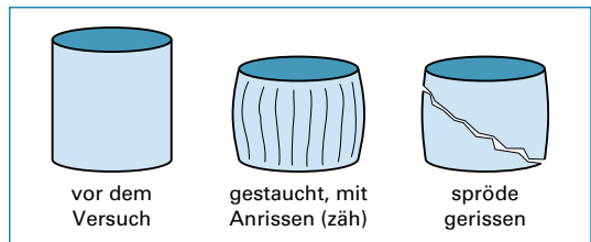
Bild 1: Probenveränderung beim Zugversuch
