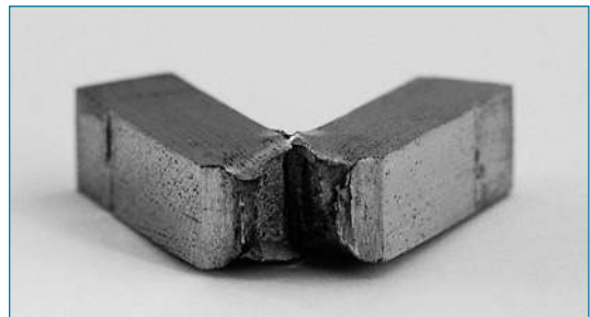
Bild 3: Kerbschlagprobe nach dem Versuch
