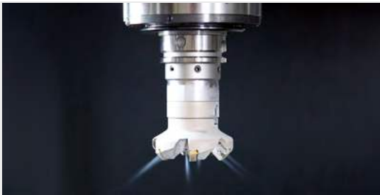
Bild 2: Fräswerkzeug mit Minimalmengenschmierung
