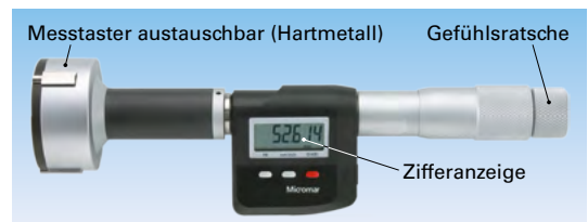
4 Innenmessschraube mit elektronischer Ziffernanzeige
