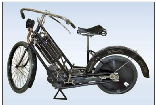
Bild 3: Das Hildebrand- und Wolfmüller-Motorrad mit Glühzündung
