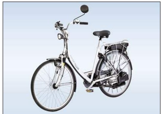
Bild 2: Leichtmofa mit Verbrennungsmotor (Saxonette Salux Fa. Sachs Fahrzeug und Motorentechnik)
