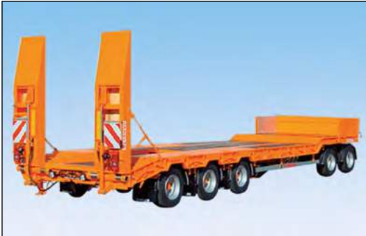
Bild 1: Spezialanhänger als Tieflader für den Fahrzeugtransport
