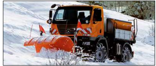
Bild 3: Fahrzeug im Winterdienst mit Antriebskonzept 4x4
