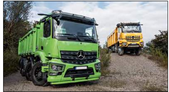
Bild 2: Baustellenfahrzeug mit Antriebskonzept 8x8/4
