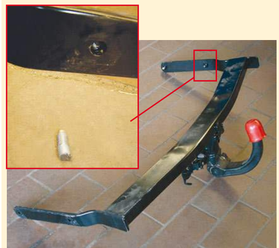
2 Abgescherte Schraube der Halterung für die Anhängervorrichtung
