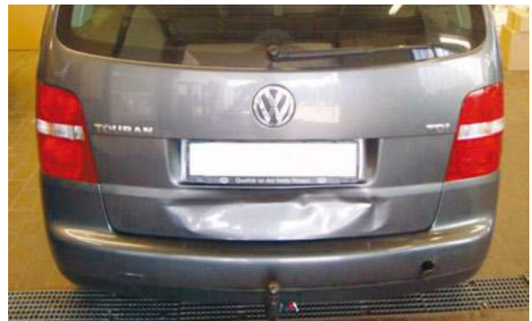
1 Beschädigtes Heck des Pkws nach dem Auffahrunfall
