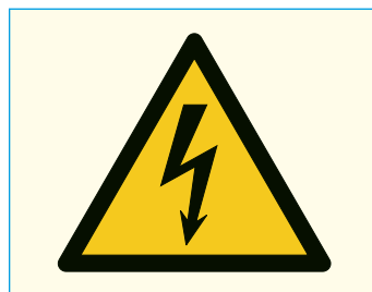
Bild 1: Warnung vor gefährlicher elektrischer Spannung
