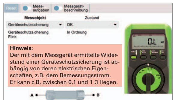
Bild 3: Widerstandsmessung einer Geräteschutzsicherung
