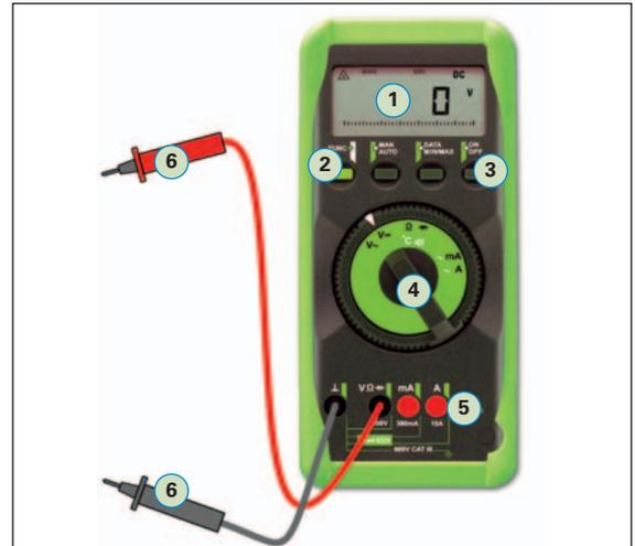
Bild 1: Vielfachmessgerät (Multimeter)
