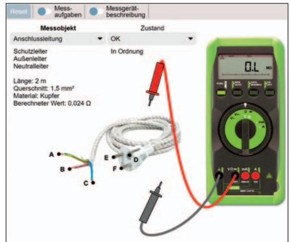
Bild 3: Prüfen einer Netzanschlussleitung
