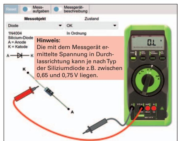
Bild 4: Prüfen einer Diode
