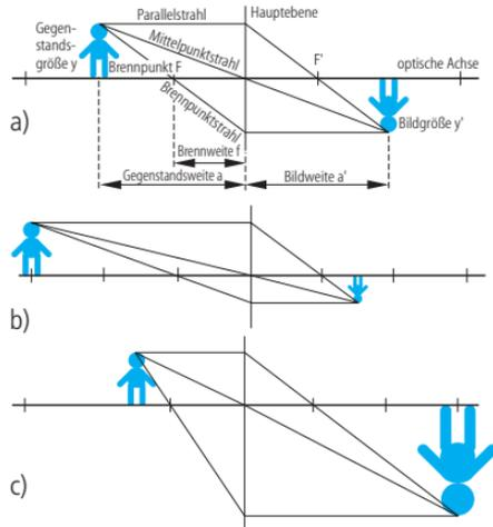
**23** Welchen Verlauf nehmen in einem optischen System die drei Hauptstrahlen zur Bildkonstruktion?
