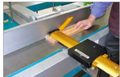
5 Betriebliche Sicherheitseinrichtung, Messerwellenabdeckung bei einer Abbrichtobelmaschine
