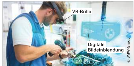
Bild 4: Augmented Reality in der Montage
