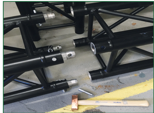
Bild 5: Traversenverbindung (Konus und Pins)
