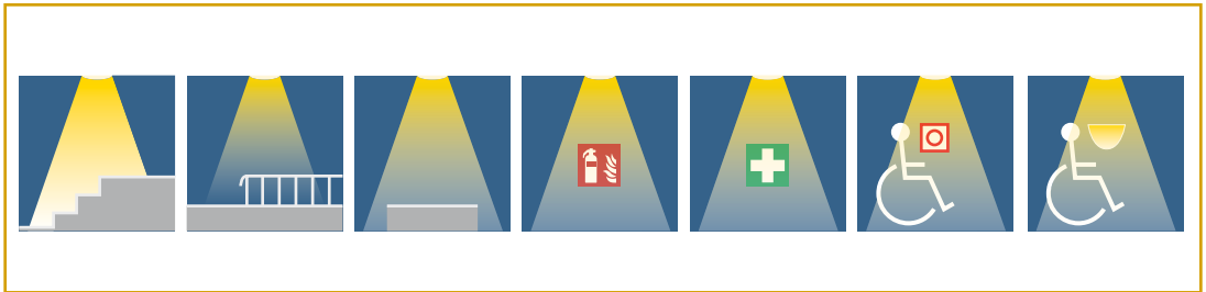
Bild 1: Sicherheitsbeleuchtung markanter Stellen
