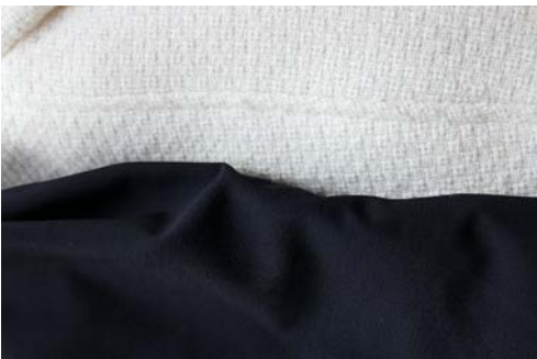
3 Veste émettant des peluches (claires) et absorbant les peluches (foncées)
