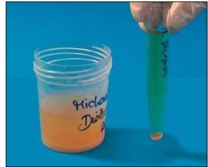
Abb. 2: Zentrifugenröhrchen nach der Zentrifugation
