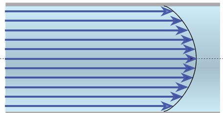
Abbildung 1-3 laminare Strömung
