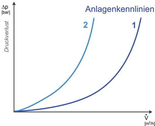
Abbildung 1-6 Anlagenkennlinien
