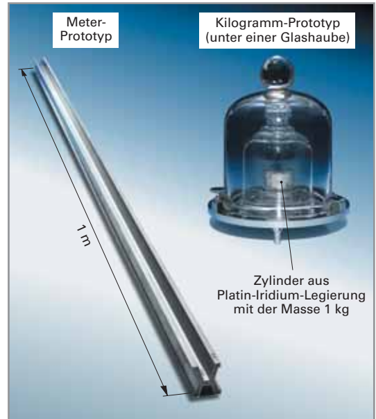
Bild 1: Kilogrammprototyp und Meterprototyp
