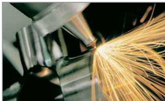
Bild 4: Laserschneiden von Stahlblech
