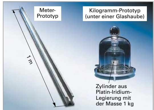
Bild 1: Herkömmliche Definition der Basisgrößen durch den Meter- und Kilogramm-Prototyp
