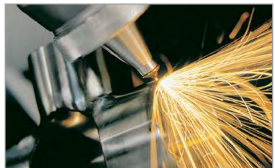
Bild 4: Laserschneiden von Stahlblech
